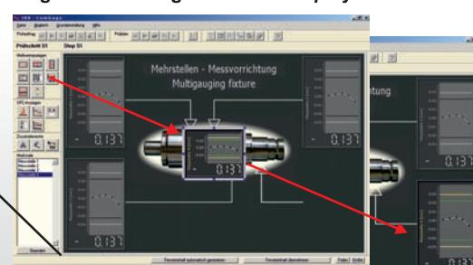
Zur Führung des Werkers durch den Messablauf können bis zu 128 frei gestaltbare Anzeigefenster angelegt werden.
